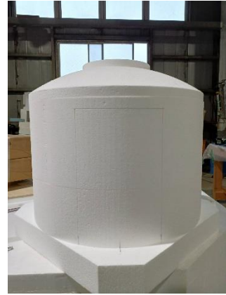
写真-4 津波避難タワー模型 (1/50縮尺モデル)
