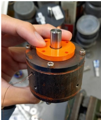
図4 腕用可変負荷発生器（片軸タイプ，実物）
