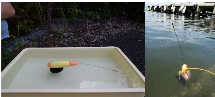
図1. 浮力調整: 左 調整前、右 調整後
