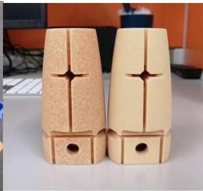
図5. 耐水圧実験後の浮力体 左 加圧後、右 加圧前
