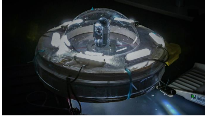
図5 改良した深良用水隧道撮影システム
