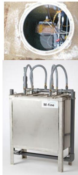
運転開始から1か月程度はやや不安定であったが、BODは良好であり、試験開始から10mg/L以下を維持し、31日目からはCOD10mg/L 及びBOD5mg/L以下の清澄な処理水が得られた。なお、T-Nの除去性能は、発揮されなかった。また、膜分離槽内のMLSS濃度は、図4に示すように徐々に増加する傾向が認められた。
